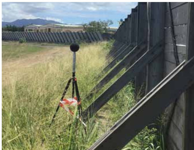
Campagne de mesure de bruit (à l'aide de sonomètres comme ici) aux abords de l'aéroport.
