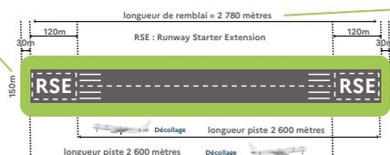
Longueur totale du remblai-digue supportant la piste, comprenant les marges de sécurité RSE (Runway Starter Extension) à chaque extrémité : 2 780 mètres.
